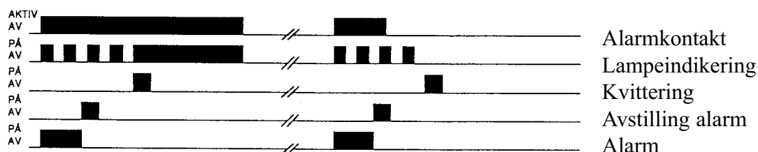
Fig. 7.1 Eksempel på indikeringssekvens for signalanlegg
